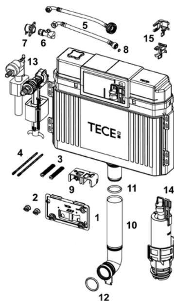
**9820100 – застенный смывной бачок (h = 820 мм) для установки с напольным унитазом, фронтальное или горизонтальное расположение панели смыва**
