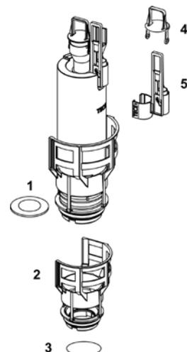
**Набор ограничительных колец для регулирования скорости смыва клапана А2**
