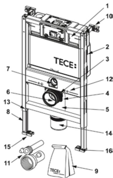
**9300031 – застенный модуль (h = 1120 мм) для установки подвесного унитаза, фронтальное расположение панели смыва**
