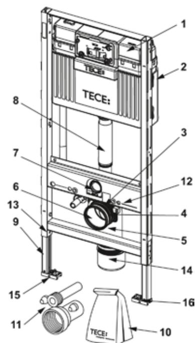
**9300066 – застенный модуль (h = 1340 мм) для установки подвесного унитаза Keramag Espiral, фронтальное расположение панели смыва**
