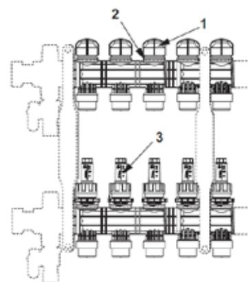
**77450000 – насосно-смесительный узел для поверхностного отопления**
