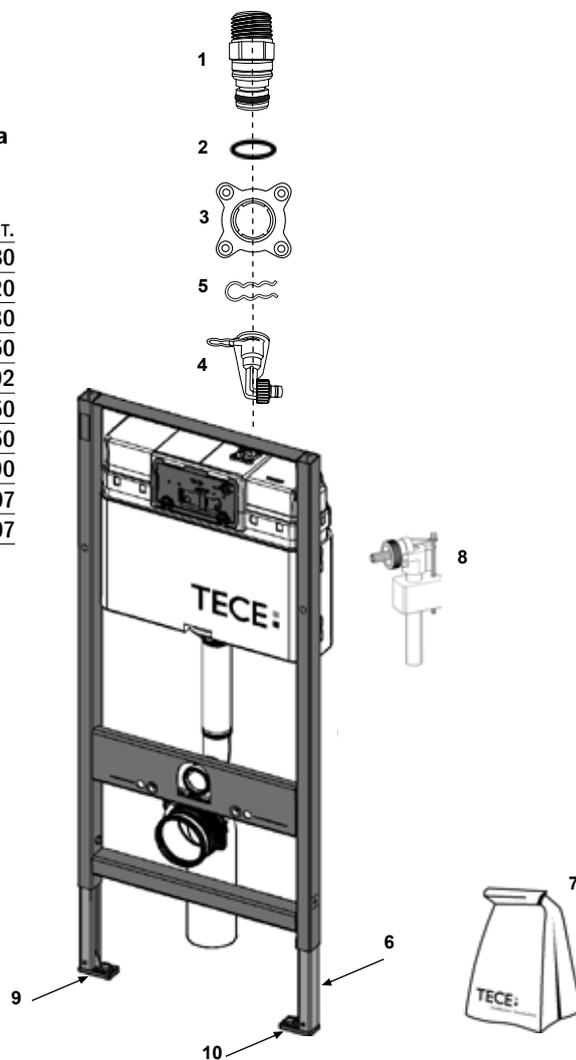
**9300001 – застенный модуль (h = 820 мм) для установки подвесного унитаза, фронтальное или горизонтальное расположение панели смыва**
