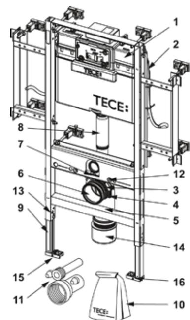
**9300075 – застенный модуль (h = 1120 мм) для Duravit SensoWash C, Geberit AquaClean 8000/8000 plus, фронтальное расположение панели смыва**
