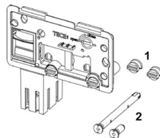
**Набор ограничительных колец для регулирования скорости смыва клапана A2**
