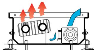
PLUS - ПОВЫШЕННОЙ ТЕПЛОПРОИЗВОДИТЕЛЬНОСТИ (С НАКЛОННЫМ ТЕПЛООБМЕННИКОМ)
