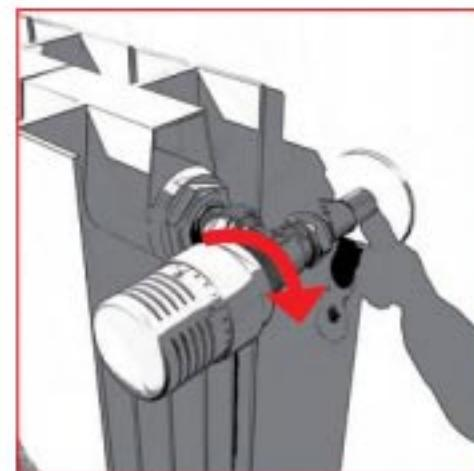
Терmostатические клапаны могут быть соединены с термоголовками с помощью простой операции. Это преобразование в термоклапан м.б. осуществлено даже в работающей системе.
